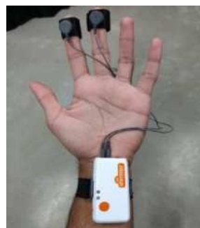
ภาพที่ 19 การวัดการตอบสนองของผิวหนัง (GSR)
